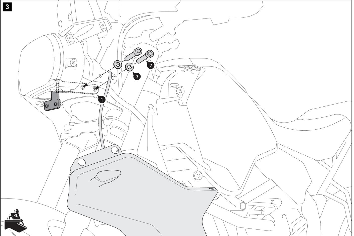
Verschrauben Sie das Anbaublech (1) auf der linken Fahrzeugseite innenseitig am Lenkkopf.
