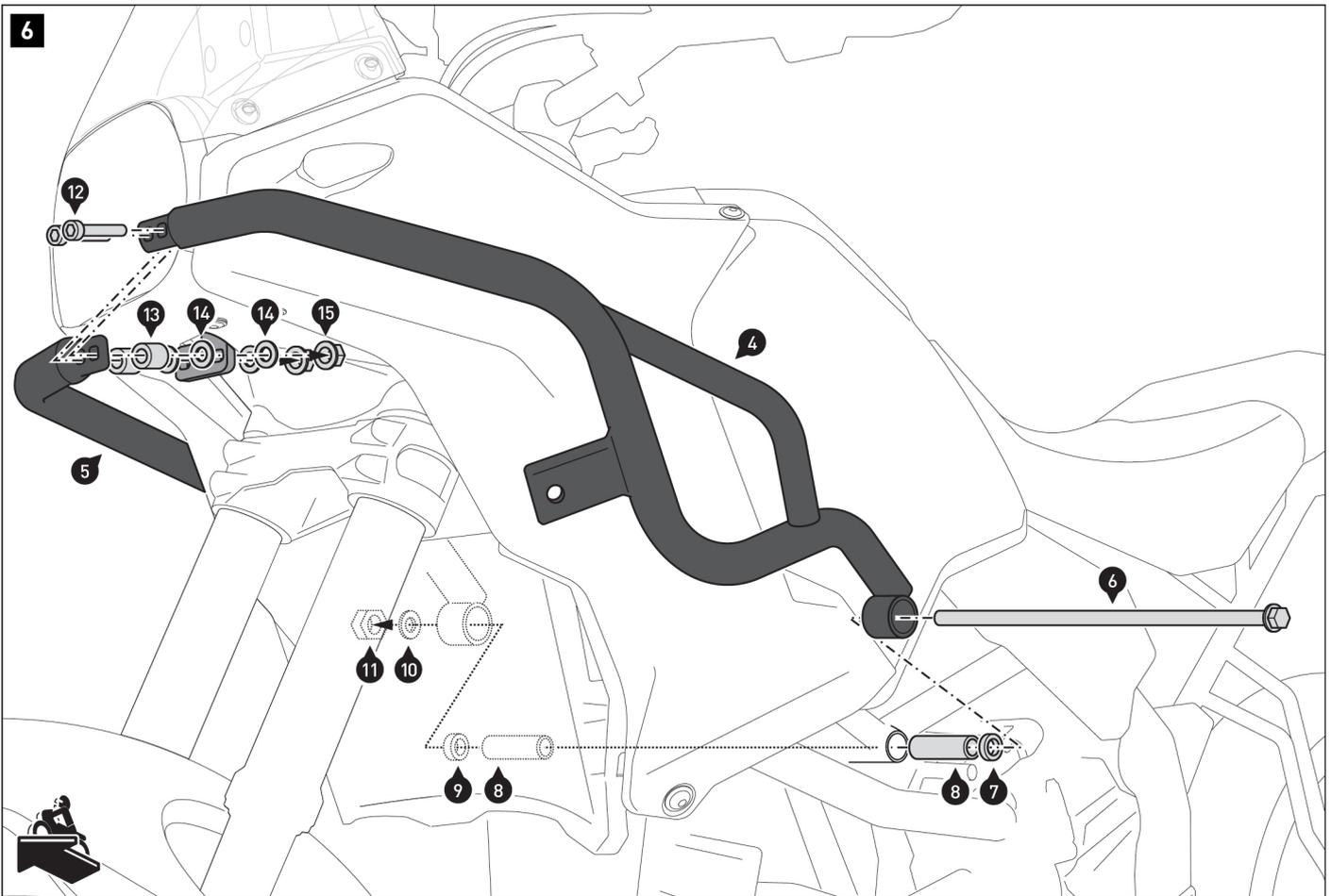
**HINWEIS:** Bei gleichzeitigem Verbau der Stürzbügel mit dem SW-MOTECH Motorschutz entfallen die Distanzbuchsen (7) und (9).
