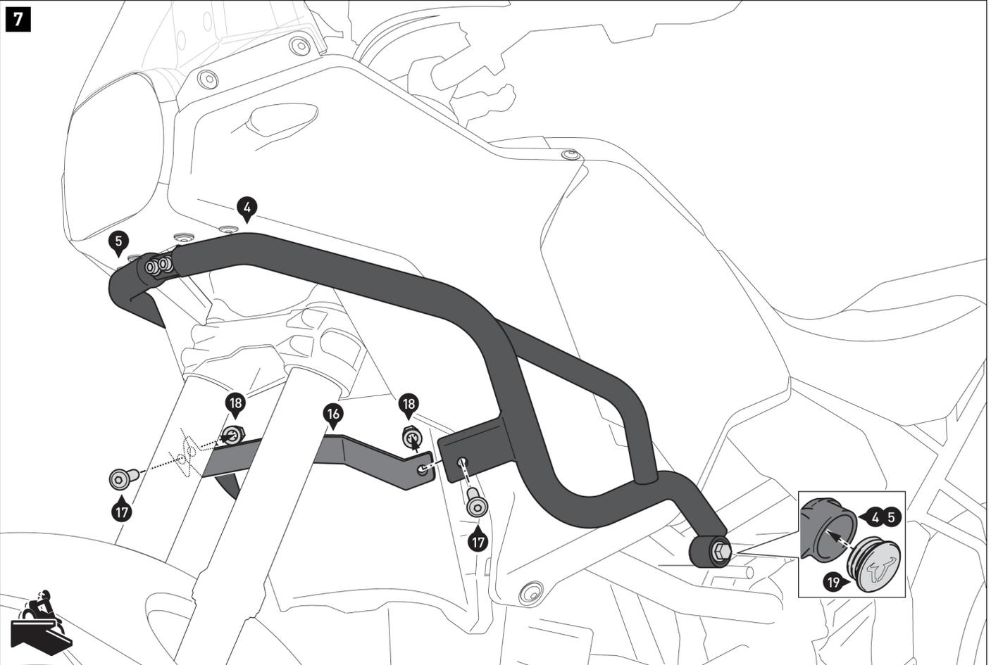
Verschrauben Sie nun den Querverbinder (16) an den Sturzbügelhälften (4) und (5).
