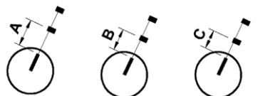
S2.1 - Durchhang Messungen Vorderseite
